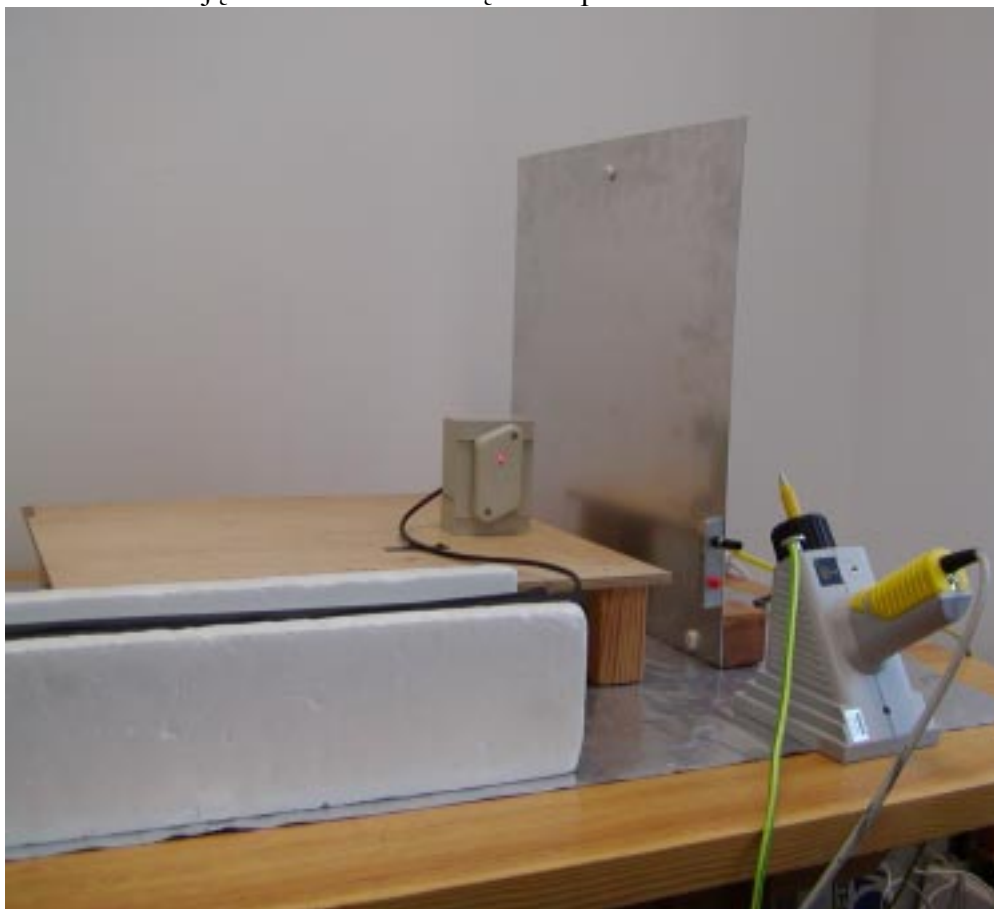
Photo No. 1 The tested devices under ESD test Zdjęcie nr 1 Badane urządzenie podczas badań ESD
